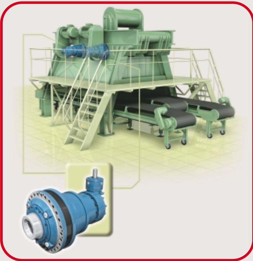
Nel ciclo di pre-lavorazione dei mattoni estrusi operano una o più macchine, che hanno lo scopo di ridurre la granulometria dell'argilla a dimensioni uniformi e di eliminare l'eventuale presenza di impurità. I filtri rotanti hanno questo compito importante. Per assicurare bassi consumi di energia ed elevate produzioni, vengono impiegati i riduttori epicicloidali Brevini della Serie S.
